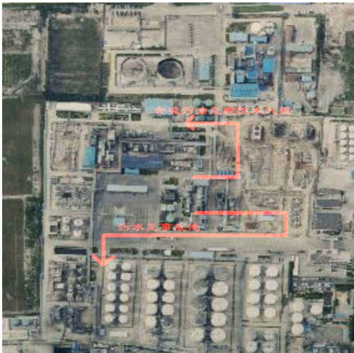
图 4-2 事故排水控制管线图
